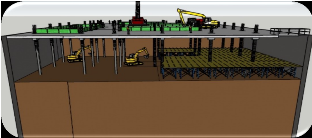
Figura 10d Colocación de cimbra para el Sótano 2
