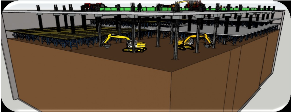
Figura 10g Continua sub-excavación para el Sótano 4
